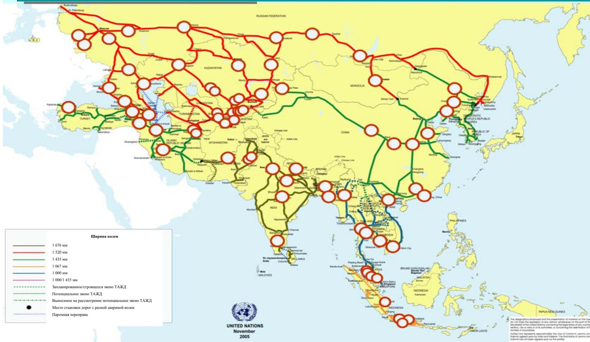
Диаграмма 2: Станции сети Трансазиатских железных дорог с контейнерными терминалами для обработки соответствующих нормам ИСО контейнеров длиной по крайней мере 20 футов.
