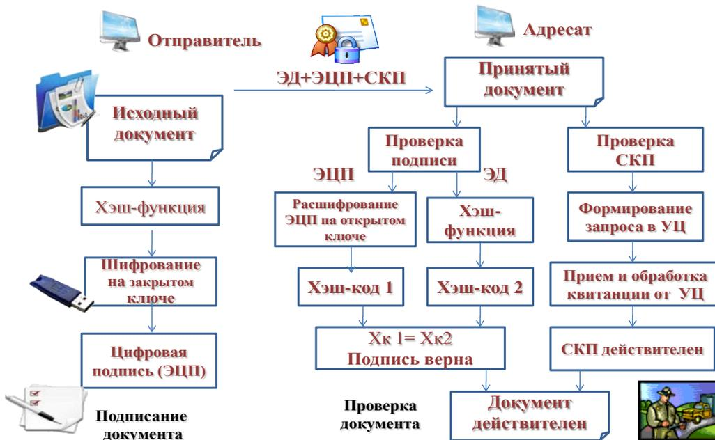
**Рис. 5.** Схема формирования и валидации ЭЦП.
